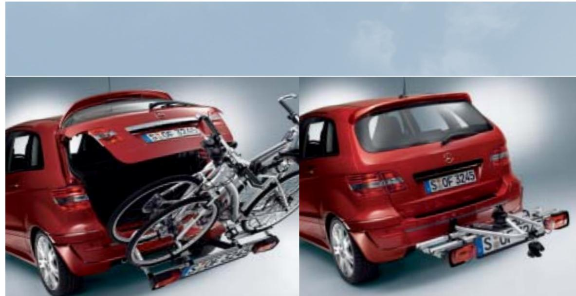
*Der beladene Heckfahrradträger lässt sich nach hinten abschwelen und erlaubt so das Öffnen der Heckklappe.*
